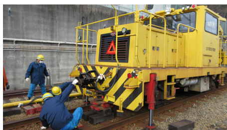
軌道モーターカーの脱線復旧訓練
