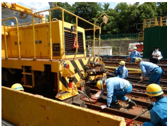
ダンプトラック脱線復旧訓練
